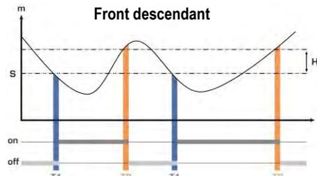
Mesure (m) < Seuil (S) pendant la temporisation T1 → Activation de l'alarme.
