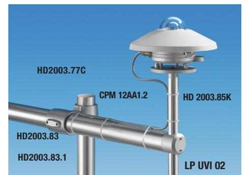
L'excellent accord entre la réponse de LP UVI 02 et cosinus (erreur f2 3.5%) vous permet de l'utiliser même lorsque l'élévation du soleil est faible (la composante diffuse de la lumière solaire ultraviolette augmente à mesure que le soleil s'éloigne du zénith, de sorte que l'erreur sur la composante directe due à une réponse imparfaite selon la loi du cosinus, devient négligeable sur la mesure du rayonnement global).
