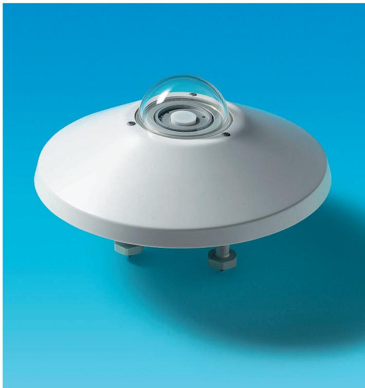
Les sondes radiométriques LP UVA 02, LP UVA 02AC et LP UVB02AV mesurent l'irradiance globale dans les UVA sur une surface plane (Watt/ m2). L'irradiance est la somme de l'irradiance solaire directe et de l'irradiance diffuse du ciel.
