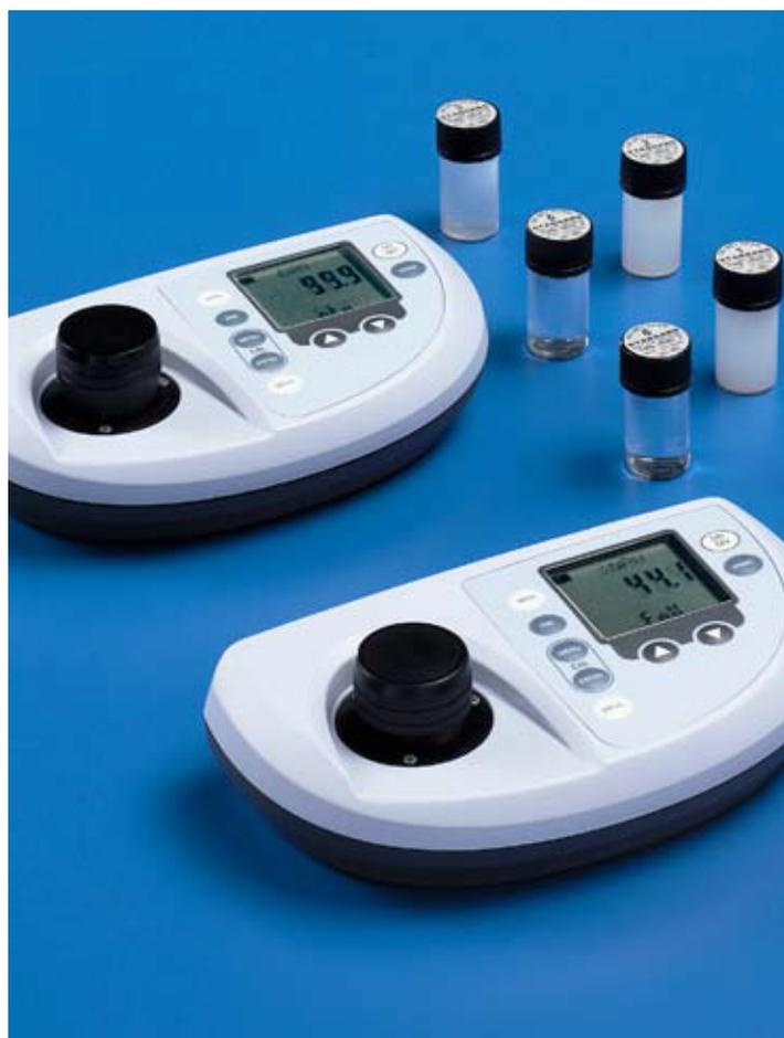
Le **HD25.2** est un turbidimètre numérique de laboratoire et portable pour la mesure de l'eau potable, eaux d'écoulement ou liquides de procédé. Il fonctionne selon le principe de mesure néphélométrique (90°).
