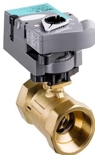
1. Avant de monter le kit, débrayez le moteur et faites pivoter l'axe dans le sens anti-horaire pour l'amener en butée. Faire également pivoter l'axe du kit dans le sens anti-horaire jusqu'à l'amener en butée. Emboîtez le kit dans les encoches du moteur en s'assurant que les picots de son axe sont alignés sur les logements de la poignée du moteur.
