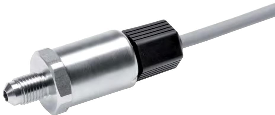
Les transmetteurs compacts de la série 520 sont basés sur la technologie à couche épaisse. La cellule de mesure est soudée au raccord de pression et ne nécessite pas de joint d'étanchéité.
