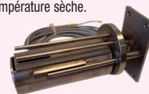
⚠ Il faut une ventilation suffisante de la sonde de température humide pour assurer une mesure psychrométrique d'humidité satisfaisante. La ventilation doit être de 2 à 3 m/s.
